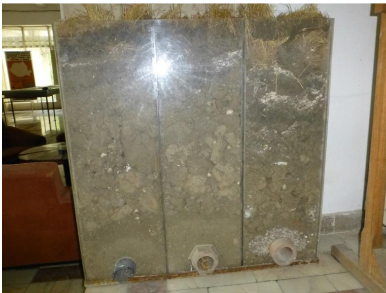
Foto 3: Modele de țevi de drenare instalate în solul Luncii Dunării. Iunie 2015, sediul ICITID, Băneasa, jud. Giurgiu. Fotografie de Ștefan Dorondel în cadrul proiectului CNCS-UEFISCDI PN II-ID-PCE-2012-4-0587 (2013–2016)
